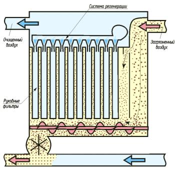
Установки серии «ФРИ» являются рукавными фильтрами с импульсной регенерацией фильтров сжатым воздухом и предназначены для очистки воздуха от пыли в различных областях промышленности
